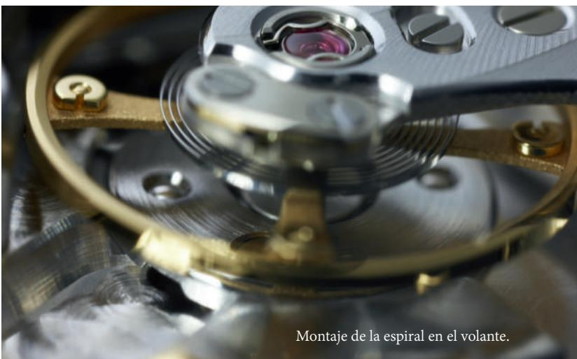
Montaje de la espiral en el volante.
